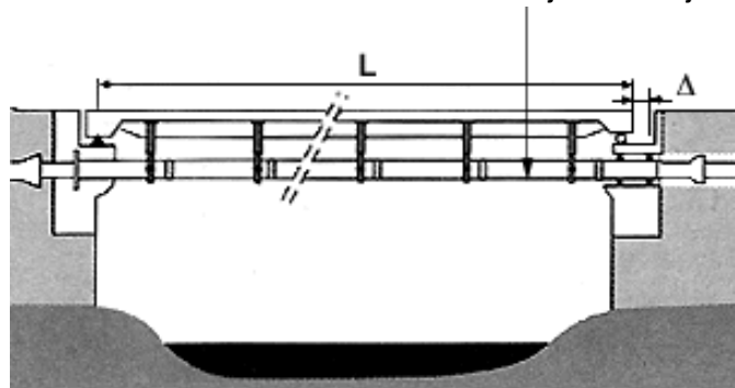
Caño con junta acerojada
